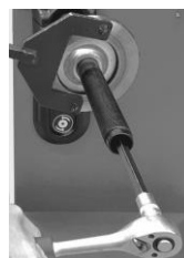
Рисунок 2 – Затяжка вала с помощью ключа
