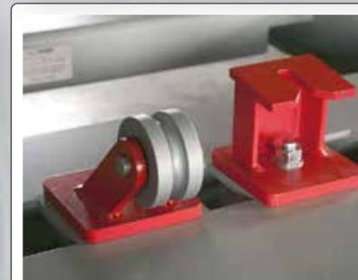
На платформу могут крепиться доп. аксессуары. Ролик для направления усилия вытяжки вниз и фиксатор цепи в комплекте.
